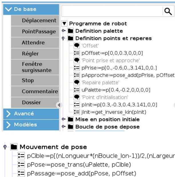
Un point (variable de type "pose") est défini en cartésien par ses 6 coordonnées exprimées en mètre et en radian, exemple pPrise (on reconnaît le Rx = 180°).
